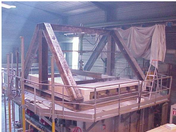
Photo 4 : Essai d'un plafond sous solives acier et couverture de dalles de béton cellulaire (chargement par vérin)
