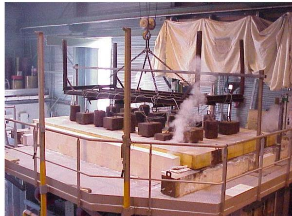
Photo 5 : Essai d'un plafond sous plancher bois (chargement uniforme par des poids morts)
